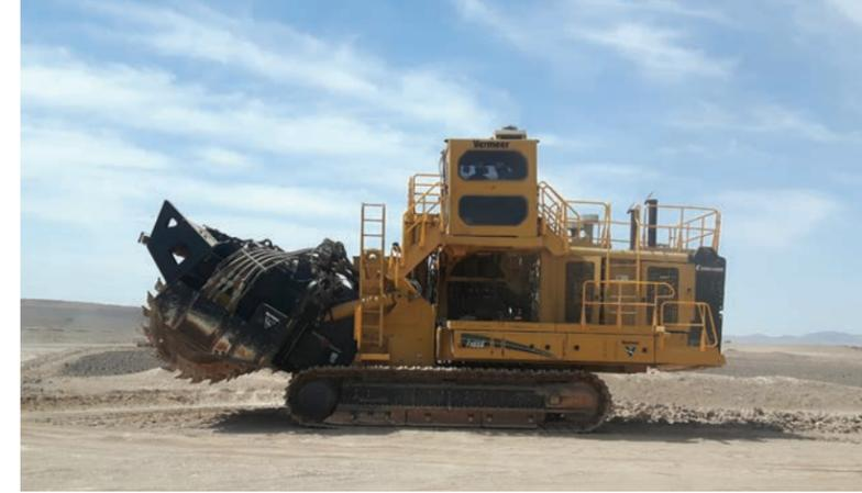
Alrededor del 95% del material cortado con el Terrain Leveler SEM, produjo tamaños de partículas por debajo de 25,4 centímetros (10 pulgadas).
